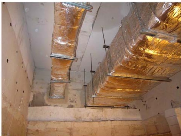
INSTALLAZIONE IN FORNO 4X3 METRI E SECONDO LA NORMA EN 1366-5: 2010
